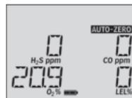
4. Когда **AUTO-SPAN** отображается и
